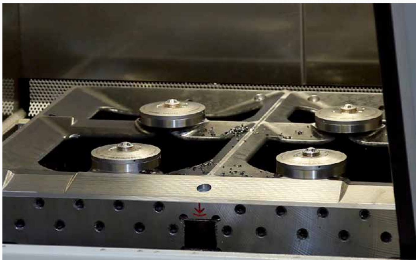
渦輪式高端自動化零點定位裝置（編號 420919）在全自動化機器人上料中使用。
