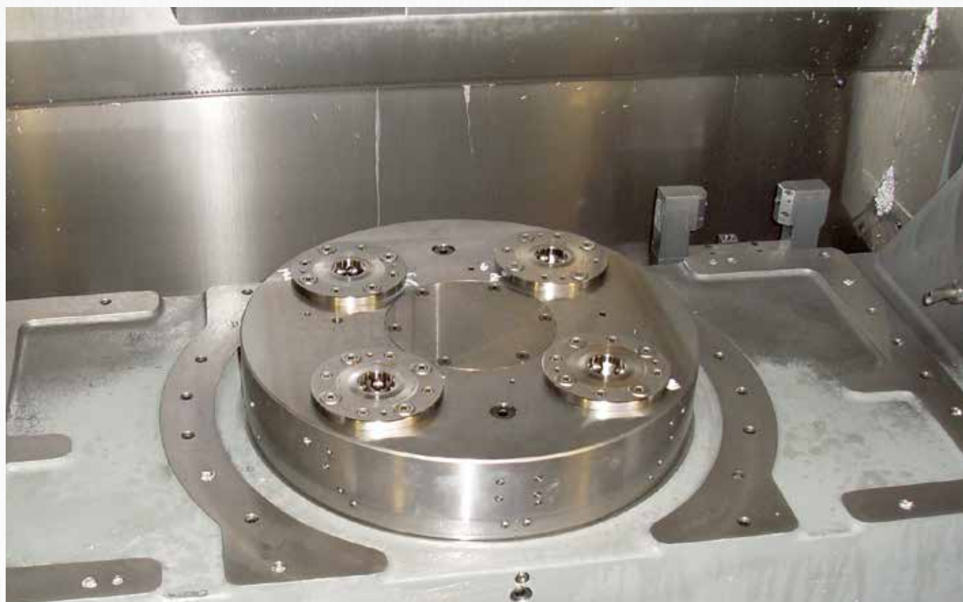
自動化解決方案（編號 427161）有鎖緊、間隙檢測和接頭感應，應用於自動化生產線中的機器人自動上料。
